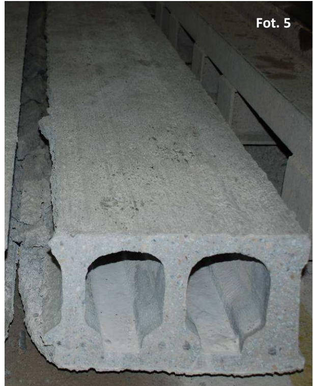
Fot. 4,5 Wygląd powierzchni górnej płyty ciętej wzdłuż metodą „na mokro”
